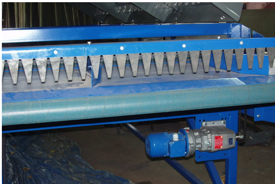
Rysunek 2. Grzebień rozciągający. Z tyłu widoczne są prowadnice formujące szerokość
