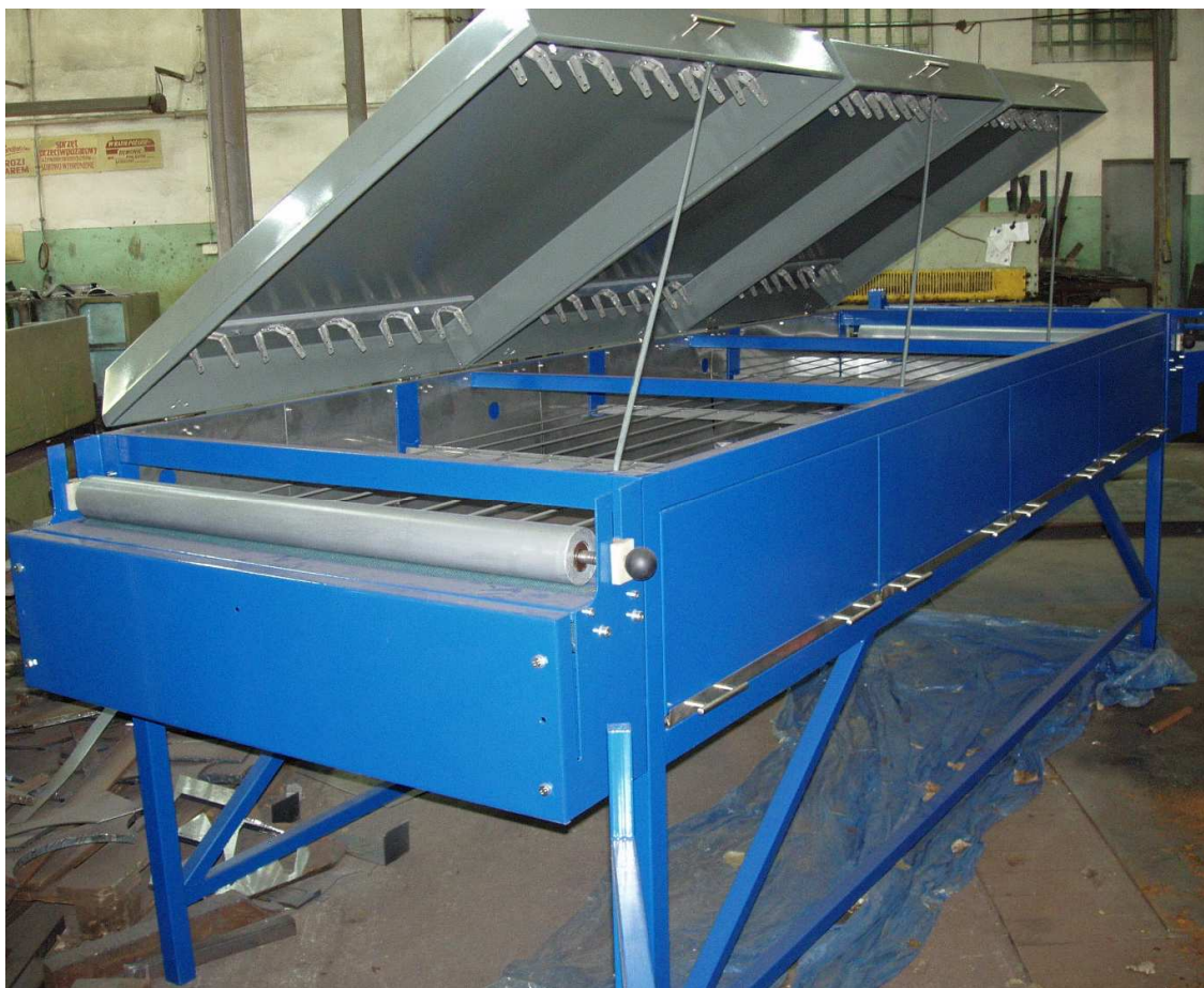
Rysunek 3. Maszyna przygotowana do montażu grzałek . Widoczny wałek grawitacyjny dociskowy
